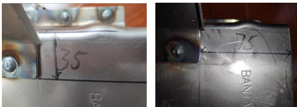
(E 板件板件下边缘到 B 板件上端面距离为 35mm, E 板件板件前边缘到 B 板件前端距离为 75mm)
