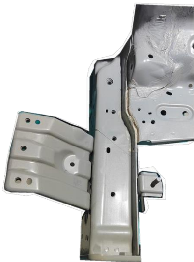
图 1 左前纵梁上部
